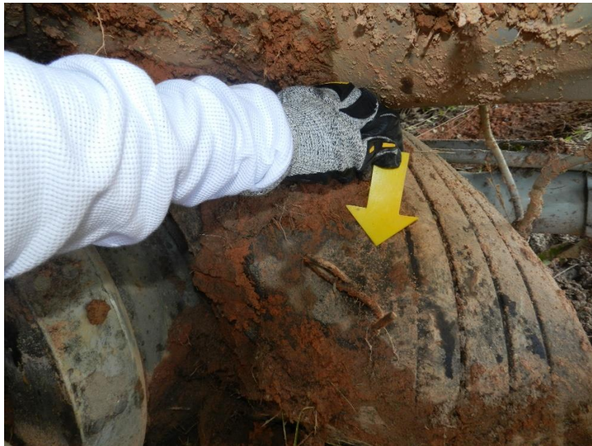
Imagen No. 2 – Evidencia de la inrustación de la varilla de hierro en el neumático
