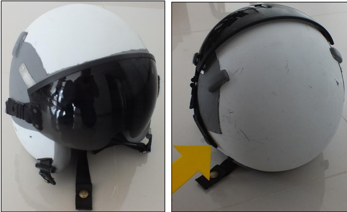
Fotografía No.4 y 5: Casco de vuelo, equipo protector usado por el piloto, en el cual se aprecian algunas marcas que protegieron su cabeza
