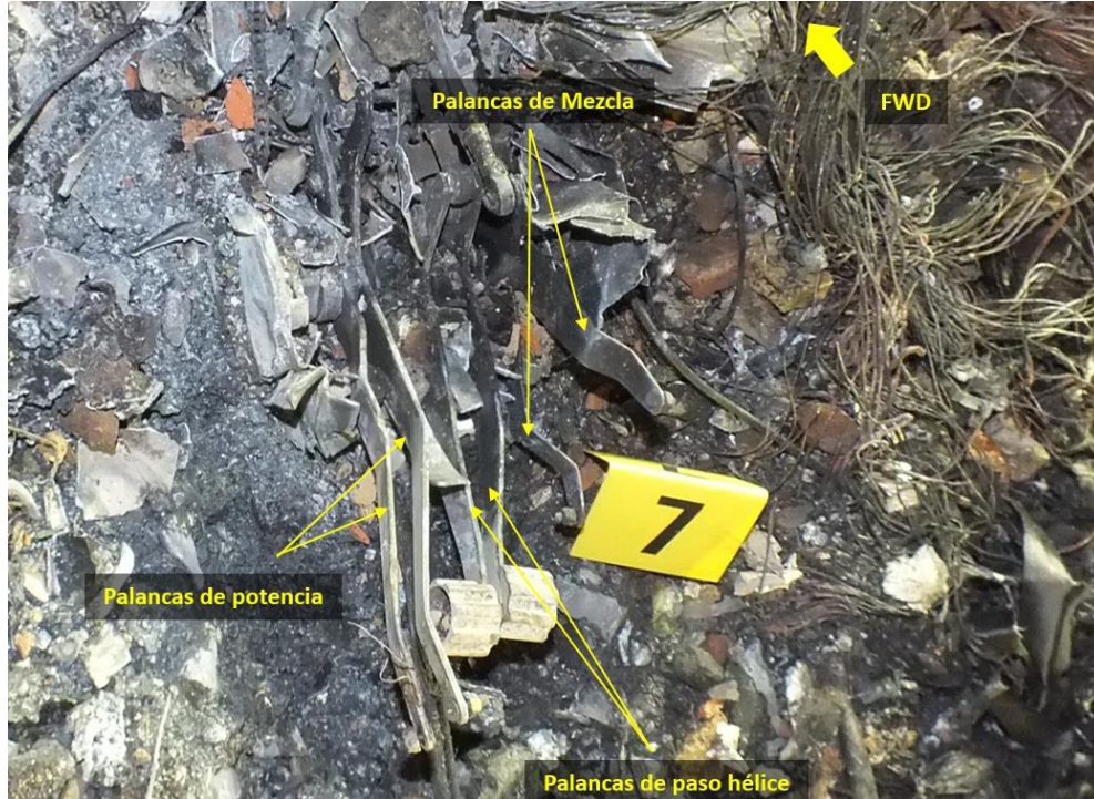
Posiciones de las palancas en cabina durante la inspección inicial
