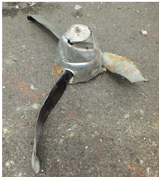
Apariencia final de la hélice derecha RH
