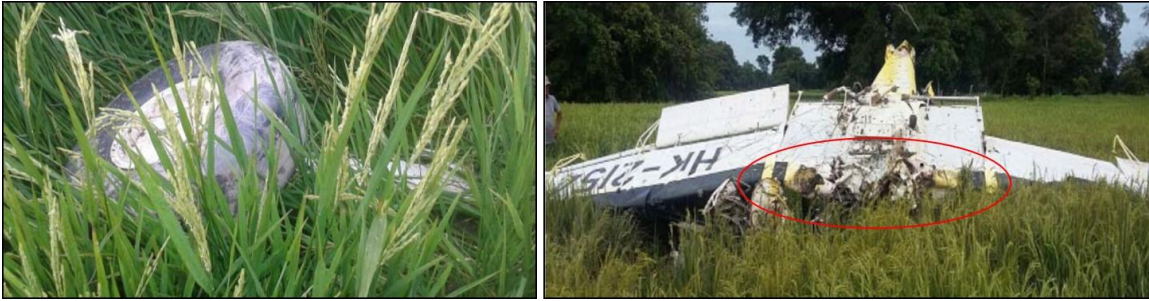
Desprendimiento de los trenes de aterrizaje principales
