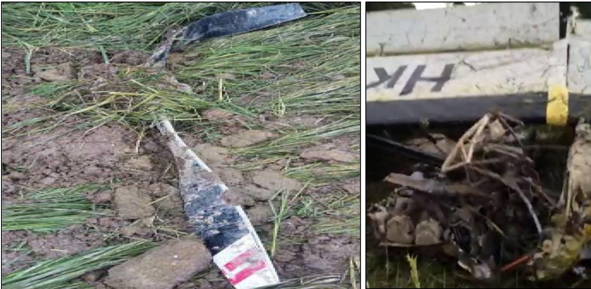
Desprendimiento de la hélice y el motor
