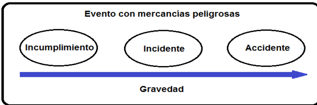
Figura 8.4 - 1 Acontecimiento con mercancías peligrosas por nivel de gravedad
