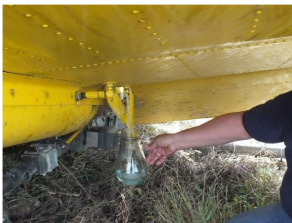
Fotografía 6. Drenaje de Combustible Aeronave HK4615
