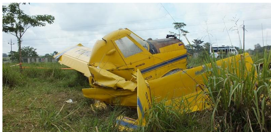
Fotografía 3. Deformación por Torsión y Compresión / Empenaje
