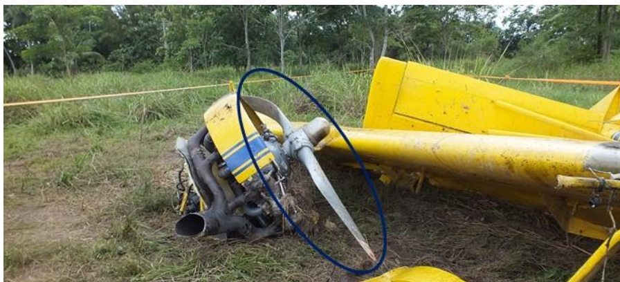
Fotografía 2. Hélice Sin Signos de Potencia / Motor
