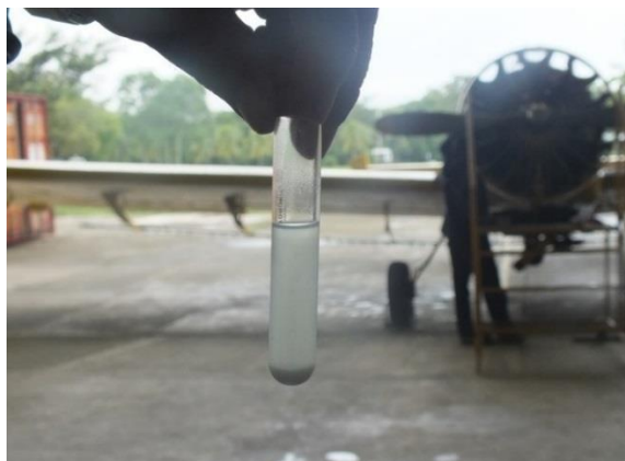
Fotografía 7. Prueba Claro y Brillante Combustible Aeronave HK4615
