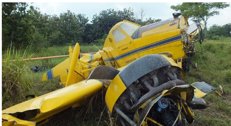
Fotografía 4. Desprendimiento del Motor desde la Bancada
